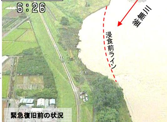
小規模出水（浅原橋：Qp=約1,500m<sup>3</sup>/s：整備計画の目標流量の約40%）時に、河岸に向かう流れが発生し、釜無川浅原地区の河岸浸食が発生
