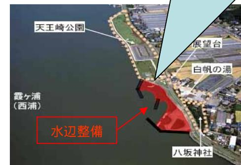
突堤・離岸堤と砂浜の再生により、水辺への利便性向上を図るとともに、波による河川管理施設への被害が低減される
