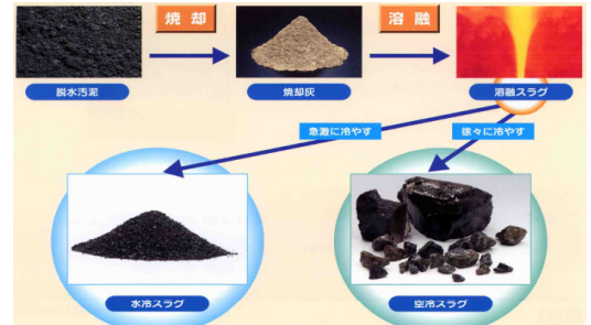
下水汚泥処理(エコスラグ化)の工程
