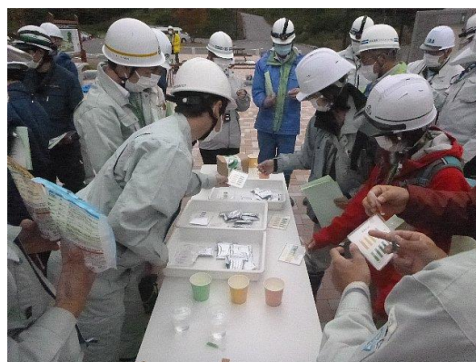
②水質簡易分析訓練（パックテストによる簡易分析）
