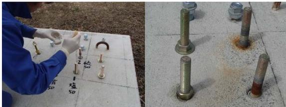
写真-5 アンカーボルトへの薬液による劣化状況
