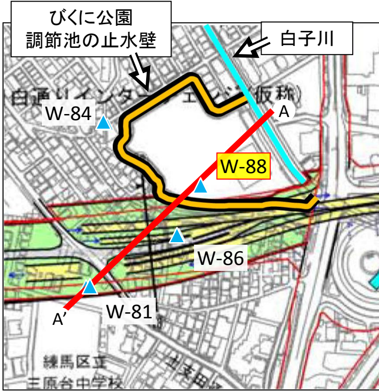
観測井と調節池の止水壁との位置関係平面図
