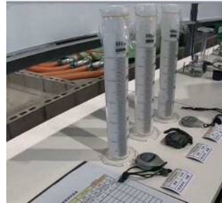
図7 気泡破泡測定状況 (左から改良気泡（濃度0.4%）、改良気泡（濃度5%）、従来気泡（濃度3%）)
