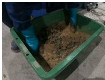
図 3 砂礫土と起泡剤溶液（起泡剤+水 発泡なし）混練状況
