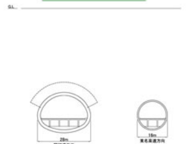
トンネル(分岐合流部)
