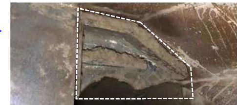
攪拌翼 【チャンバー内に取り込んだ土砂等をほぐす部材】
