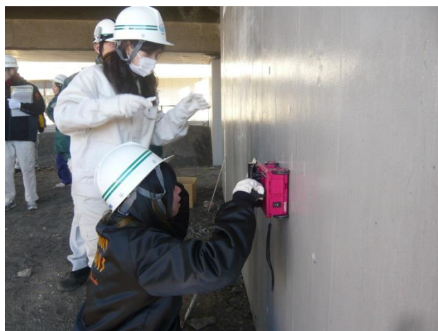
電磁レーダーによる橋脚の鉄筋探查の学習状況
