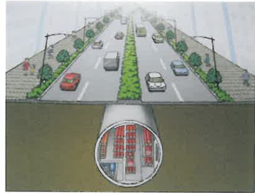
【共同溝整備後】
