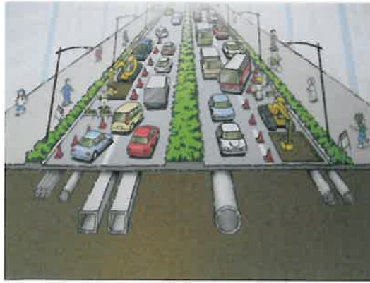
【共同溝整備前】
